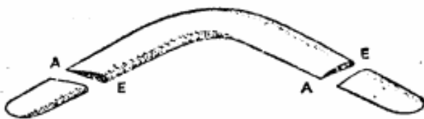
Abb. 9. Wiederkehrender Bumerang, aufgeschnitten. Die Eintrittskante (E) des einen Armes geht über in die Austrittskante (A) des anderen.
